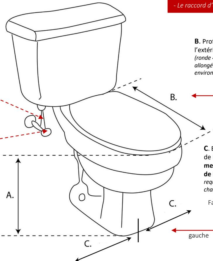
**B.** Profondeur, réservoir à l'extérieur de la cuvette. (ronde 48,26 cm / 19 po - allongée 53,34 cm / 21 po environs)
